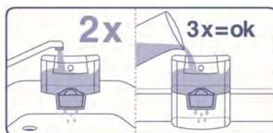
Извлеките воронку из модуля фильтра BRITA, заполните ее холодной водой из-под крана и дайте время, чтобы вся вода прошла через фильтр. Слейте воду после первых двух таких процедур. Эти две процедуры нужны, чтобы промыть кассету фильтра.
