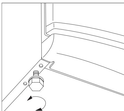
затягните винты. При установке холодильника проследите за тем, чтобы он был расположен горизонтально. Для этого используются 2 регулируемые ножки под передней частью холодильника. Не устанавливайте холодильник так, чтобы на него падал прямой солнечный свет или рядом с кухонной плитой или печью.
