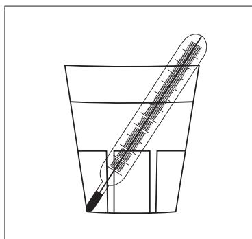
температуру продуктов, хранящихся в холодильнике, установите ручку терморегулятора в среднее положение, поставьте стакан с водой в центр камеры и опустите в него термометр с точностью градуировки +/- 1 °C. Если через 6 часов показание термометра соответствует показанию дисплея, холодильник работает нормально. Измерения необходимо проводить в
